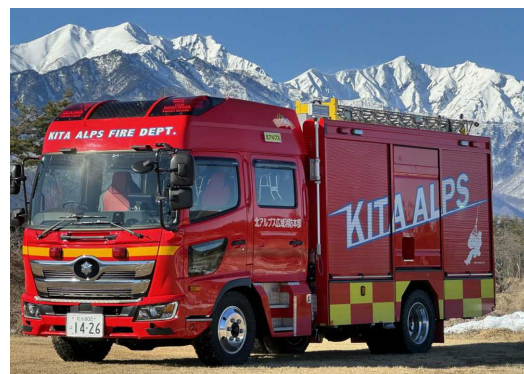
水槽付消防ポンプ自動車（令和5年度更新）
